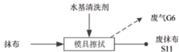
图 2-4 连接线生产工艺流程及产污示意图
